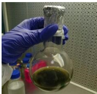
Рисунок 4.2 - Растворение клеточных стенок тканей пшеницы в ферментативном растворе
